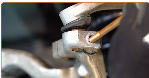
**42** Pričvrstite pritrdilne elemente zgornje ročice. Uporabite kombinirani ključ №16. Uporabite nasadni ključ №16. Uporabite navorni ključ. Zategnite ga do navora 40 Nm.
