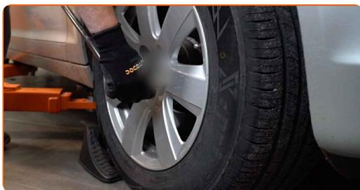
**3** Vzdignite sprednji del avtomobila in otdrite podpornike.
