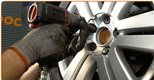
**35** Sputite avto in z delanjem v navzkrižnem vrstnem redu, zategnite kolesne vijake. Uporabite kolesni nasadni nastavek št. 17 Uporabite navorni ključ. Zategnite ga do navora 120 Nm.
