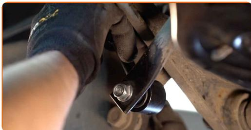
**11** Zategnite pritrdilni element, ki povezuje jarmov drog na palico stabilizatorja. Uporabite kombinirani ključ №14. Uporabite XZN št. 6. Uporabite nasadni ključ №15. Uporabite navorni ključ. Zategnite ga do navora 45 Nm.
