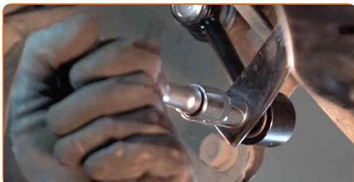
**13** Obdelajte vse spoje opornika stabilizatorja. Uporabite bakreno mast.
