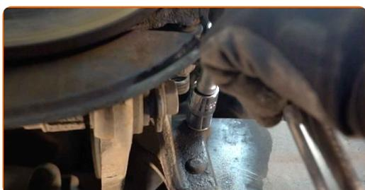
**12** Namestite pritrditev palice na stabilizator in ga zategnite. Uporabite kombinirani ključ №14. Uporabite XZN št. 6. Uporabite nasadni ključ №15. Uporabite navorni ključ. Zategnite ga do navora 45 Nm.
