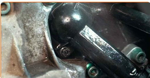
**28** Odvijte pritrdilne elemente ohišja termostata. Uporabite nasadni ključ №10. Uporabite izvijač z zatikalom.
