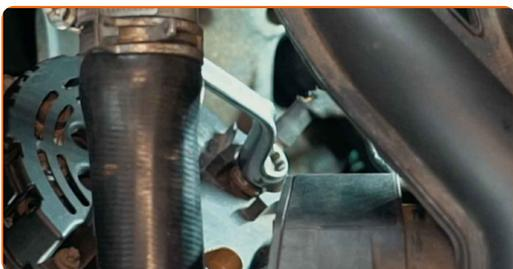
**27** Očistite ohišje termostata. Uporabite večnamenski čistilni sprej.
