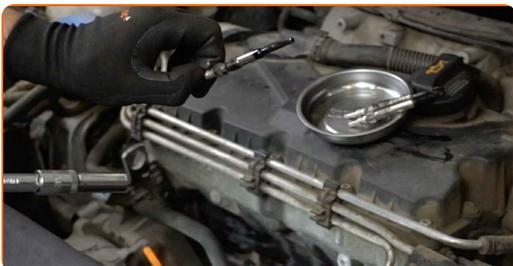
**9** Obdelajte žarilne svečke. Uporabite visokotemperaturno keramično pasto.
