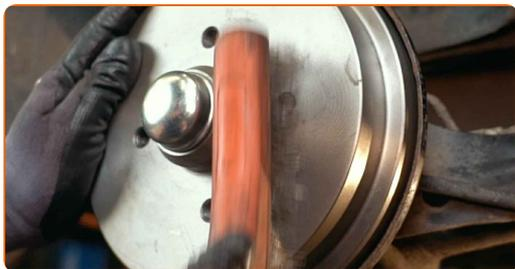
**39** Obdelajte površino, kjer se platišče kolesa dotika zavornega bobna. Uporabite bakreno mast.
