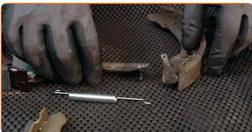
**21** Namestite nastavitveni vzvod zavornih čeljusti.
