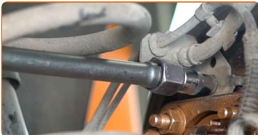
**20** Obdelajte zavorno cev. Uporabite bakreno mast.
