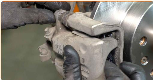
**19** Zategnite pritrdilni element zavorne cevi. Uporabite nasadni ključ №E11. Uporabite navorni ključ. Zategnite ga do navora 15 Nm.
