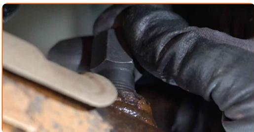
**9** Obdelajte lambda sondo. Uporabite visokotemperaturno keramično pasto.
