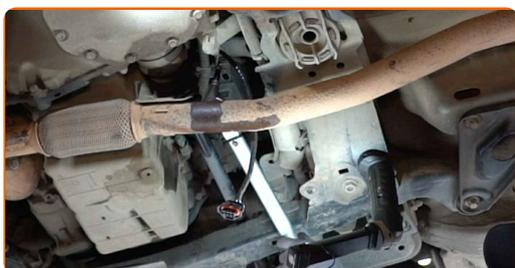
**12** Obdelajte konektor lambda sonde. Uporabite dielektrično mast.
