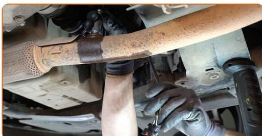
**11** Pričvrstite pritrdilni element lambda sonde. Uporabite kombinirani ključ №22. Uporabite navorni ključ. Zategnite ga do navora 32 Nm.
