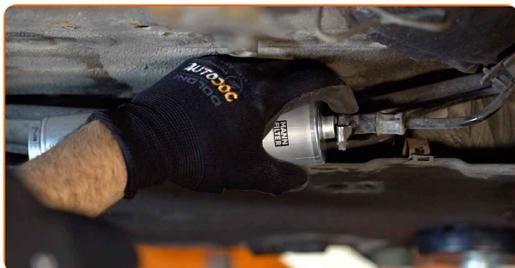
**17** Zategnite linije za dovod goriva. Uporabite ploščat izvijač.
