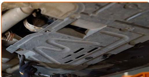
**24** Privijte pritrdilne vijake zaščitnega pokrova. Uporabite nasadni ključ №8. Uporabite izvijač z zatikalom.
