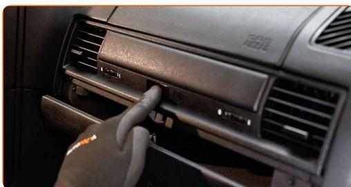
**3** Odvijte pritrtilne vijke predla pred sovoznikom. Uporabite Phillips križni izvijač. Uporabite ploščat izvijač.
