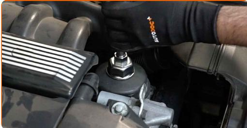
6 Pripravite posodo za stari oljni filter.
