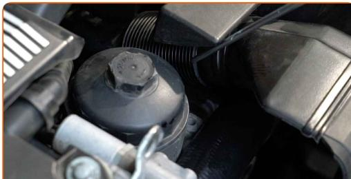
5 Odvijte ohišje pokrova filtra skupaj s starim elementom filtra. Uporabite nasadni ključ №36. Uporabite izvijač z zatikalom.
