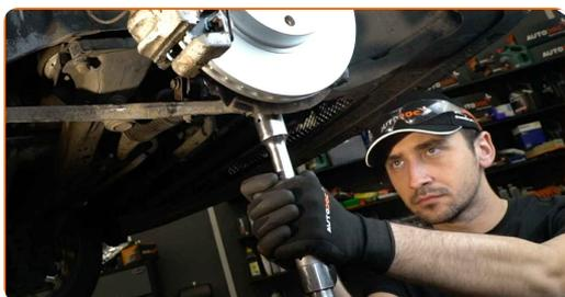
**16** Zategnite pritrdilni element, ki povezuje drog stabilizatorja z vilicami. Uporabite kombinirani ključ №17. Uporabite nasadni ključ №17. Uporabite navorni ključ. Zategnite ga do navora 42 Nm.
