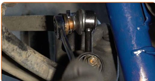
**15** Podprite ročico. Uporabite dvigalko s hidravličnim prenosom.
