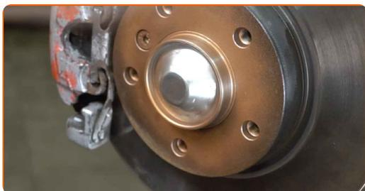
**22** Očistite površino zavornih kolutov. Uporabite čistilo zavor.
