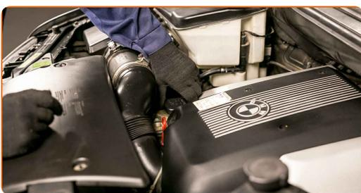
**4** Odvijte ohišje pokrova filtra skupaj s starim elementom filtra. Uporabite nasadni ključ №36. Uporabite izvijač z zatikalom.
