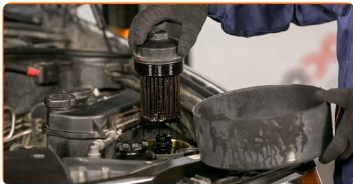
**6** Odložite stari oljni filter v posodo.
