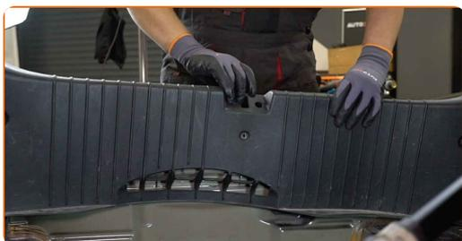
**88** Privijte pritrdilni element osrednje zaščitne plastične plošče. Uporabite Phillips križni izvijač.
