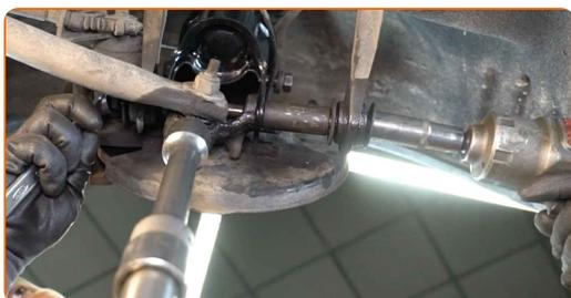
**59** Privijte pritrdilni element, ki povezuje blažilnik z zadnjim premnikom. Uporabite kombinirani ključ №19. Uporabite nasadni ključ №19. Uporabite izvijač z zatikalom.
