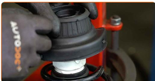
**49** Zategnite matico amortizerja. Uporabite nasadni ključ №22. Uporabite imbus št. H6. Uporabite navorni ključ. Zategnite ga do navora 65 Nm.
