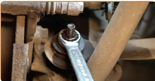
**31** Podprite zadnji premnik. Uporabite dvigalko s hidravličnim prenosom.
