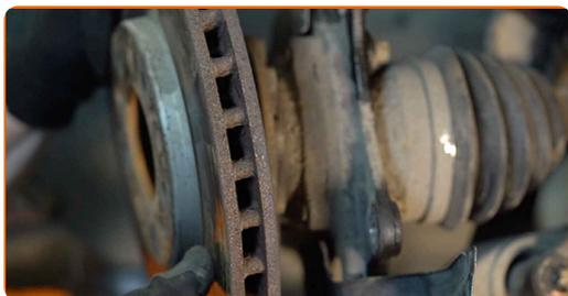
**19** Očistite pritrdilni element, ki povezuje nosilni zgib s premnikom. Uporabite žično krtačo. Uporabite sprej WD-40.
