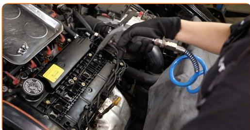
**13** Odvijte vžigalne svečke. Uporabite nastavek ključa za vžigalne svečke št. 16. Uporabite izvijač z zatikalom.
