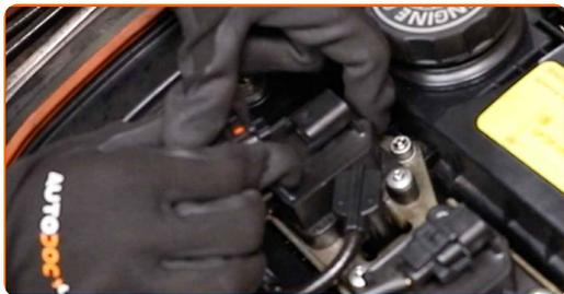
**10** Odvijte nosilec vžigalne tuljave. Uporabite vijačni nastavek T40. Uporabite izvijač z zatikalom.
