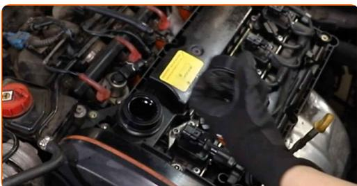
24 Namestite pokrov motorja in ga pričvrstite.
