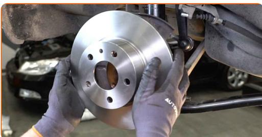
**21** Zategnite pritrditve zavornega diska. Uporabite nasadni ključ №12. Uporabite navorni ključ. Zategnite ga do navora 11 Nm.
