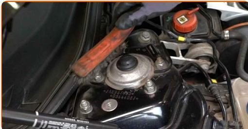
**4** Odvijte zgornje pritrdilne elemente blažilnika. Uporabite nasadni ključ №17. Uporabite izvijač z zatikalom.
