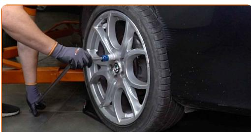
**7** Vzdignite sprednji del avtomobila in otdite podpornike.
