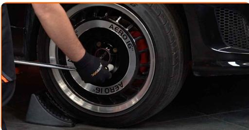
4 Vzdignite sprednji del avtomobila in otdrite podpornike.
