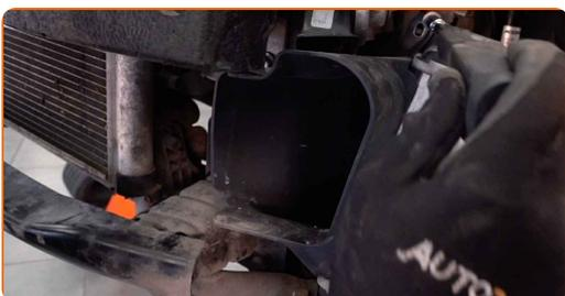
**52** Zategnite pritrdilne elemente sprednjega vzdolžnega nosilca. Uporabite nasadni ključ №16. Uporabite nasadni ključ №18. Uporabite navorni ključ. Zategnite ga do navora 75 Nm.
