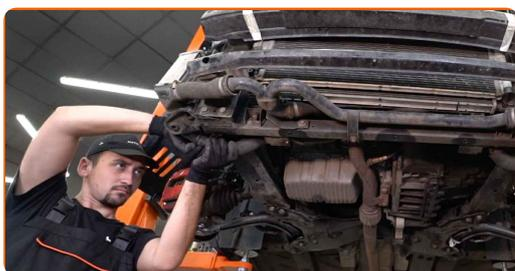
**49** Privijte zgornji element hladilnika polnilnega zraka. Uporabite nasadni ključ №10. Uporabite izvijač z zatikalom.
