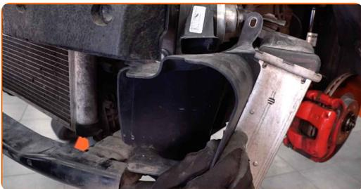
**51** Privijte pritrdilni element vodila za zrak hladilnika polnilnega zraka. Uporabite nasadni ključ №10. Uporabite izvijač z zatikalom.
