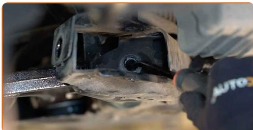
**37** Namestite zadnji pritrdilni element vodila. Ne zategnite ga.
