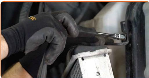
**50** Namestite vodilo za zrak hladilnika polnilnega zraka.
