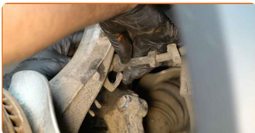
**83** Priključite napeljavo ABS senzorja.
