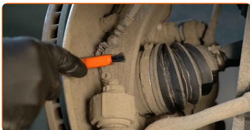
**27** Odklopite konektor ABS senzorja.
