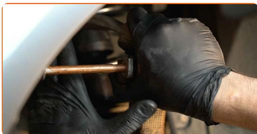
**80** Privijte pritrdilne elemente (2 kosa) zgornjih vilic. Uporabite kombinirani ključ №16. Uporabite nasadni ključ №16. Uporabite izvijač z zatikalom.
