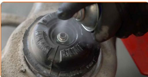
**51** Odstranite matico oporne batnice. Uporabite nasadni ključ №18. Uporabite imbus št. H6. Uporabite izvijač z zatikalom.
