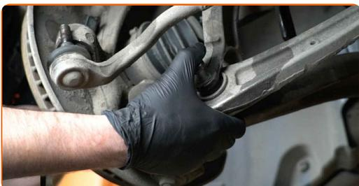
**42** Odvijte pritrdilne elemente na vrhu nosilca amortizerja.
