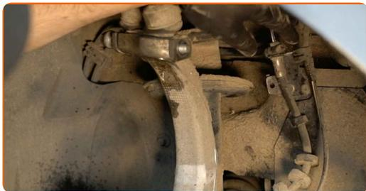
**26** Očistite konektor ABS senzorja. Uporabite čistilno krtačo iz najlona. Uporabite sprej WD-40.
