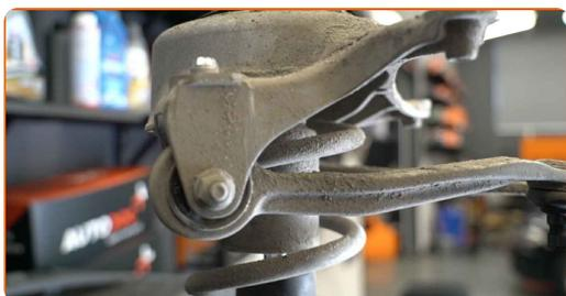
**45** Očistite pritrdilne elemente blažilnika. Uporabite čistilno krtačo iz najlona. Uporabite sprej WD-40.
