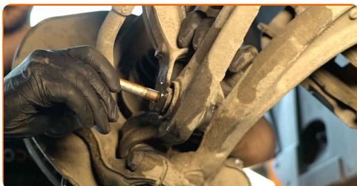
**76** Privijte pritrdilne elemente, ki povezujejo vzmetne vilice na spodnje roke. Uporabite kombinirani ključ №18. Uporabite nasadni ključ №18. Uporabite izvijač z zatikalom.
