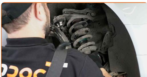
29 Nastavite opornik amortizerja na orodju kompresorja.
