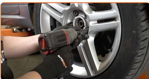
**76** Spustite avto in z delanjem v navzkrižnem vrstnem redu, zategnite kolesne vijake. Uporabite kolesni nasadni nastavek št. 17 Uporabite navorni ključ. Zategnite ga do navora 120 Nm.
