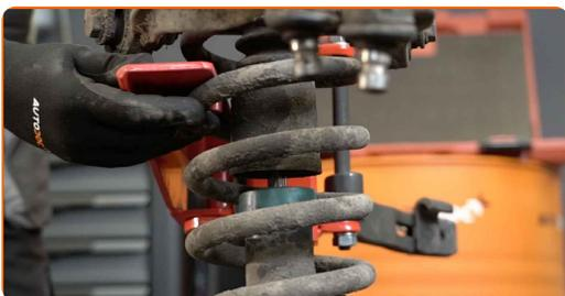
**32** Odstranite matico oporne batnice. Uporabite nasadni ključ №18. Uporabite imbus št. H5. Uporabite izvijač z zatikalom.
