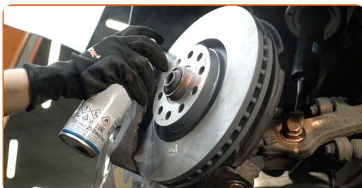
**26** Očistite površino zavornih kolotov. Uporabite čistilo zavor.
