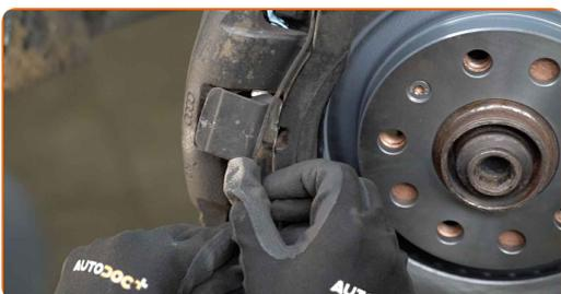
**23** Povežite senzor obrabe zavornih ploščic.
