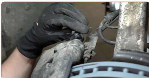
**24** Priključite vtič senzorja za obrabo zavornih oblog.
