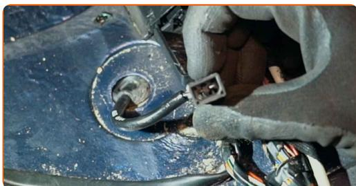
**26** Odklopite ABS-senzor. Uporabite mizarske klešče.
