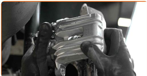
Pritrdite čeljusti na suspenzijo ali telo z žico brez prekinjanja zavore cevi, da se prepreči odklop zavornega sistema.
