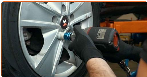
**46** Spustite avto in z delanjem v navzkrižnem vrstnem redu, zategnite kolesne vijake. Uporabite kolesni nasadni nastavek št. 17 Uporabite navorni ključ. Zategnite ga do navora 120 Nm.
