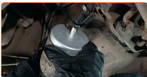
**15** Privijte pritrdilne vijake nosilca filtra za gorivo. Uporabite nasadni ključ N°10. Uporabite izvijač z zatikalom.
