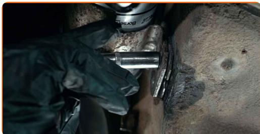
**16** Zategnite pritrdilne objemke cevi filtra za gorivo. Uporabite ploščat izvijač.
