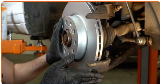
**18** Zategnite pritrditve zavornega diska. Uporabite vijačni nastavek T30. Uporabite navorni ključ. Zategnite ga do navora 4 Nm.
