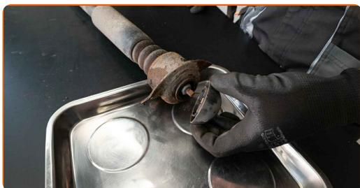
13 Očistite pritrdilni element blažilnika v obliki palice. Uporabite žično krtačo. Uporabite sprej WD-40.
