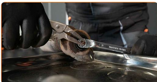
15 Odstanite nosilec amortizerja, protiprašno zaščito in blažilec amortizerja.
