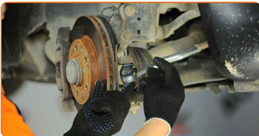
**16** Zategnite pritrdilno matico, ki povezuje glavo jarmovega droga s premnikom. Uporabite nasadni ključ №18. Uporabite navorni ključ. Zategnite ga do navora 30 Nm.+90°
