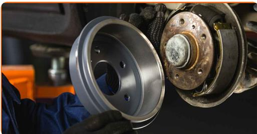
**12** Zategnite pritrdilne elemente zavornega bobna. Uporabite ploščat izvijač. Uporabite vijačni nastavek T30. Uporabite navorni ključ. Zategnite ga do navora 10 Nm.
