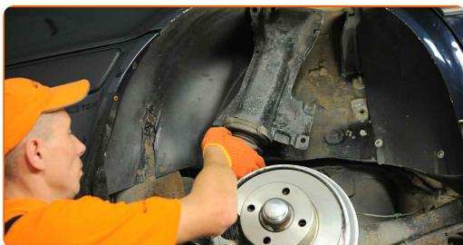
**31** Zategnite zgornje pritrdilne elemente blažilnika. Uporabite nasadni ključ №17. Uporabite navorni ključ. Zategnite ga do navora 55 Nm.
