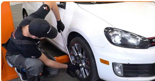
3 Vzdignite sprednji del avtomobila in otdite podpornike.
