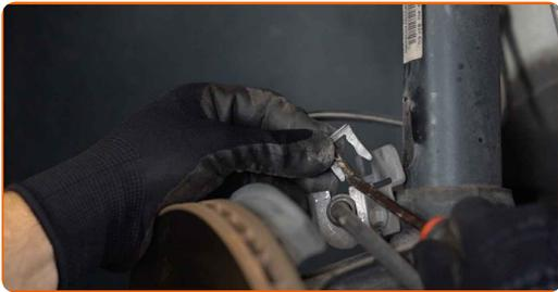
**16** Očistite pritrdilne elemente, ki povezujejo vezni element amortizerja na opornik amortizerja, in tiste, ki povezujejo opornik amortizerja s krmilnim členkom. Uporabite žično krtačo. Uporabite sprej WD-40.
