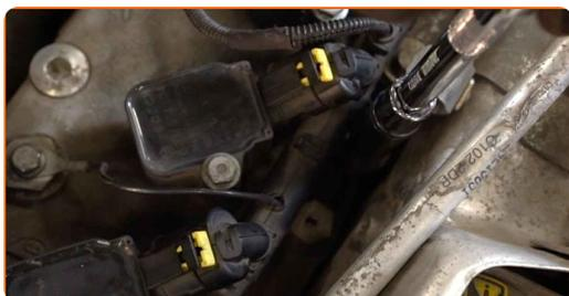
**32** Pritrdite gibko cev bloka motorja na PCV ventil. Namestite vpenjalni kos na gibko cev bloka motorja. Uporabite kombinirane klešče.
