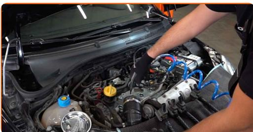
**20** Odvijte vžigalne svečke. Uporabite nastavek ključa za vžigalne svečke št. 16. Uporabite izvijač z zatikalom.
