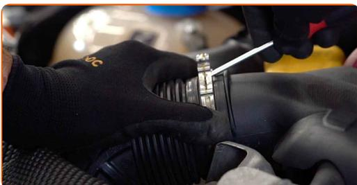
**4** Odstranite vpenjalni kos gibke cevi bloka motorja. Uporabite ploščat izvijač.
