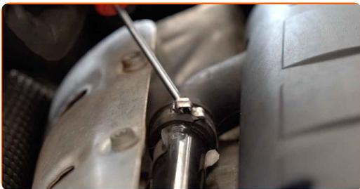
**5** Odvijte pritrdilni element pokrova motorja. Uporabite nasadni ključ №10. Uporabite izvijač z zatikalom.
