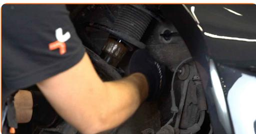
21 Nastavite opornik amortizerja na orodju kompresorja.
