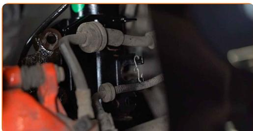
37 Popravite opornik amortizerja na členku volana. Namestite nove vijake premnika.
