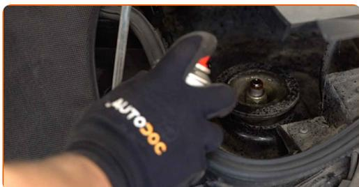
6 Odvijte pritrdilne elemente na vrhu nosilca amortizerja. Uporabite kombinirani ključ №19. Uporabite imbus št. H7. Uporabite izvijač z zatikalom.
