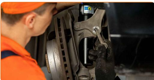
59 Zategnite pritrdilni element nosilca opornika stabilizatorja. Uporabite nasadni ključ №16. Uporabite izvijač z zatikalom. Uporabite navorni ključ. Zategnite ga do navora 65 Nm.
