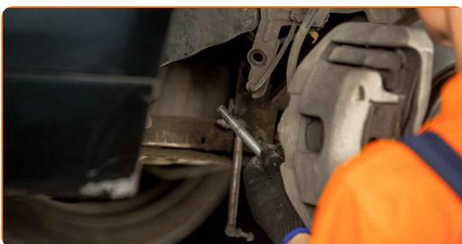
**16** Odstranite nosilec z opornika amortizerja.
