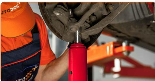
57 Namestite nosilec na opornik amortizerja.
