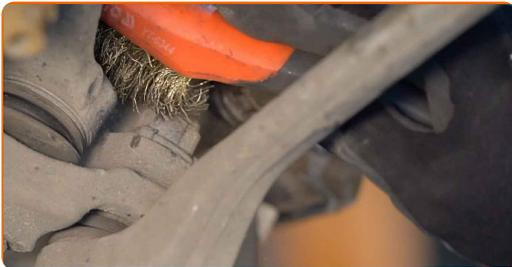
21 Odvijte spodnji pritrdilni element, ki povezuje blažilnik s premnikom. Uporabite kombinirani ključ №18. Uporabite nasadni ključ №16. Uporabite izvijač z zatikalom.
