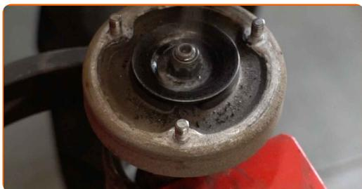
**33** Odstranite matico oporne batnice. Uporabite imbus št. H6. Uporabite nasadni ključ N°18. Uporabite izvijač z zatikalom.
