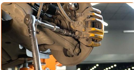
**64** Povežite senzor obrabe zavornih ploščic.
