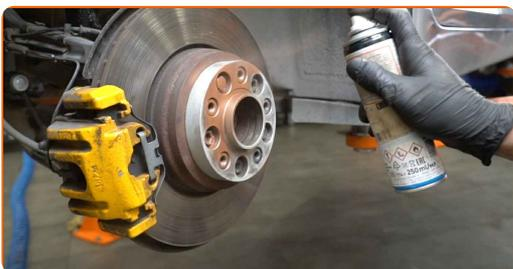
**68** Očistite površino zavornih kolutov. Uporabite čistilo zavor.
