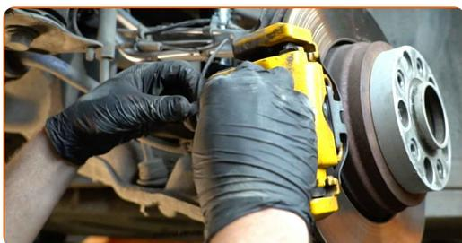
**65** Obdelajte vse dele prečnega vodila. Obdelajte pritrdilne elemente blažilnika. Uporabite bakreno mast.
