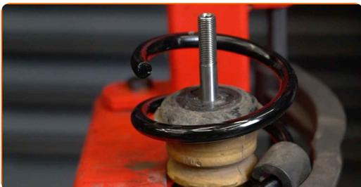
**43** Namestite zgornji nosilec opornika in ležaj nosilca opornika.
