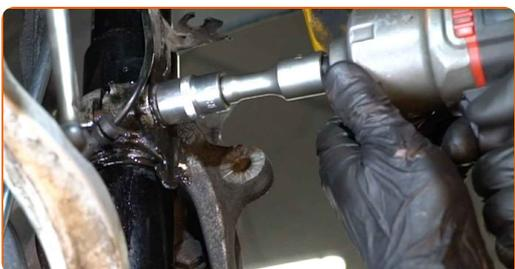
**18** Odvijte pritrdilni element nosilca opornika stabilizatorja. Uporabite nasadni ključ №16. Uporabite izvijač z zatikalom.
