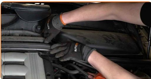
**10** Odvijte pritrdilne elemente ohišja filtra za notranji zrak. Uporabite nasadni ključ №13. Uporabite izvijač z zatikalom.
