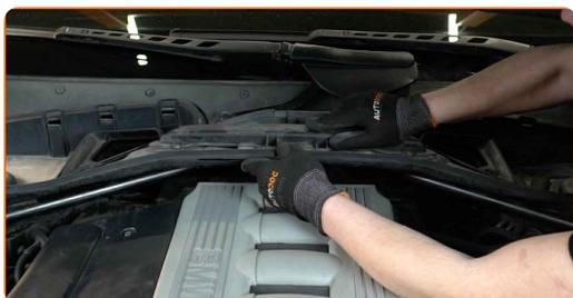
**48** Privijte pritrdilne elemente spodnjega dela ohišja filtra kabine. Uporabite nasadni ključ №13. Uporabite izvijač z zatikalom.
