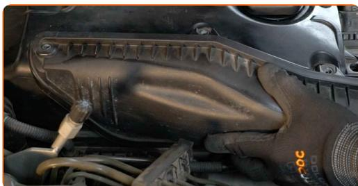
**39** Privijte pritrdilni element sesalne cevi. Uporabite imbus št. H5. Uporabite izvijač z zatikalom.
