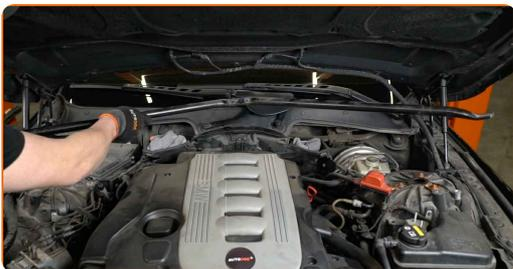
**19** Odvijte pritrdilni element pokrova motorja. Uporabite imbus št. H5. Uporabite izvijač z zatikalom.
