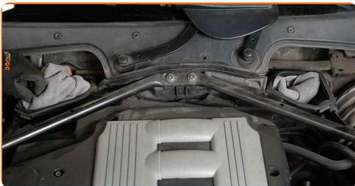
**17** Odvijte pritrdilne elemente diagonalnih letev. Uporabite vijačni nastavek T40. Uporabite izvijač z zatikalom.
