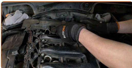
**41** Privijte pritrdilne elemente zadnjega dela pokrova motorja. Uporabite imbus št. H5. Uporabite izvijač z zatikalom.
