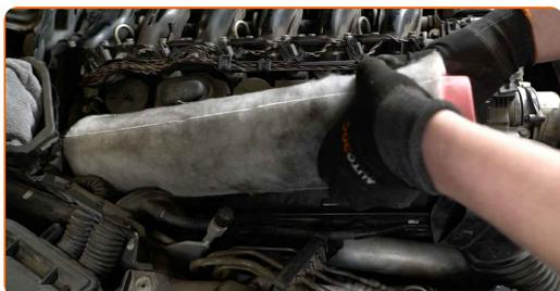
**31** Očistite pokrov zračnega filtra in ohišje.
