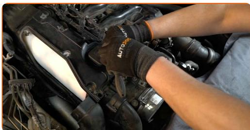
**38** Priključite dovodno cev zraka na ohišje zračnega filtra.
