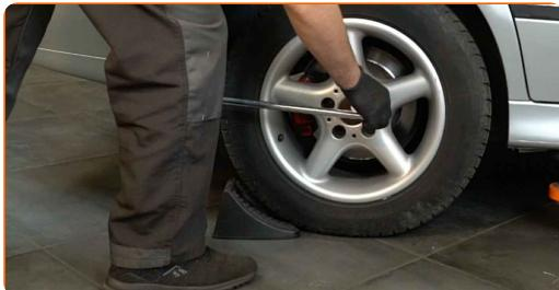
**3** Vzdignite zadnji del avtomobila in otrditе podpornike.
