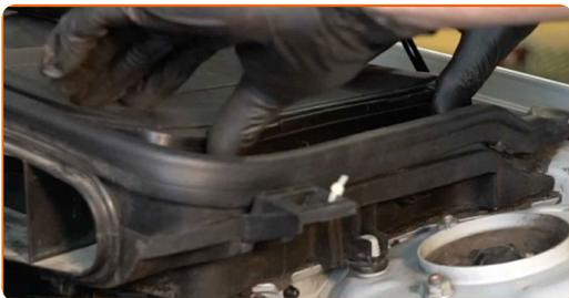
**40** Namestite ohišje zračnega kanala.
