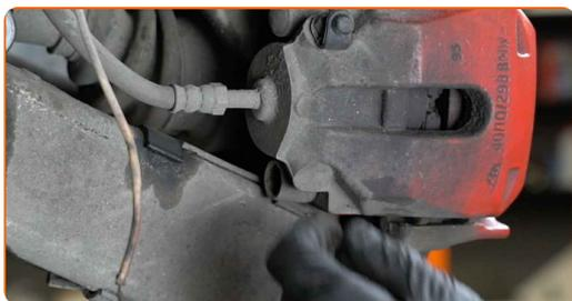
**16** Odvijte pritrditve zavorne čeljusti. Uporabite imbus št. H7. Uporabite izvijač z zatikalom.
