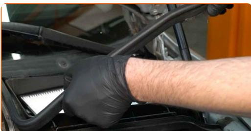
**7** Odstranite ohišje zračnega filtra kabine.
