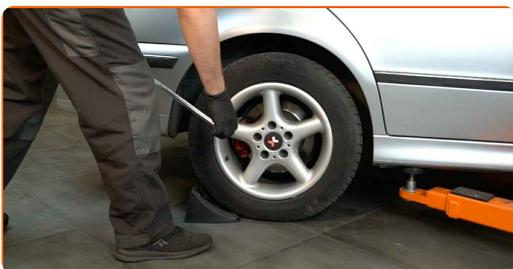
11 Vzdignite zadnji del avtomobila in odkrite podpornike.
