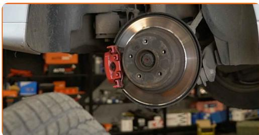
**14** Odklopite senzor obrabe zavornih ploščic. Uporabite lomilko.
