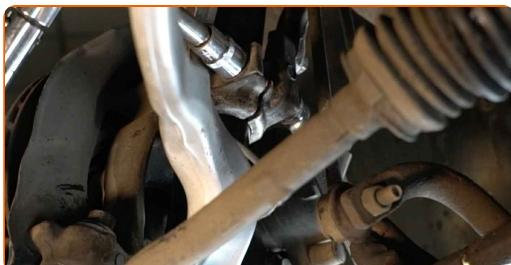
**23** Zategnite sprednji pritrdilni element, ki povezuje obeso koles s pomožnim okvirjem. Uporabite kombinirani ključ №18. Uporabite nasadni ključ №18. Uporabite navorni ključ. Zategnite ga do navora 110 Nm.
