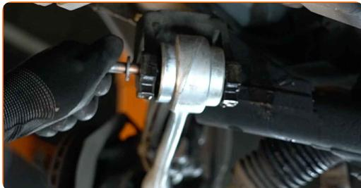
**20** Privijte pritrditev sprednje roke. Uporabite kombinirani ključ №18. Uporabite nasadni ključ №18. Uporabite izvijač z zatikalom.
