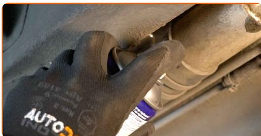
**14** Odvijte nosilec filtra za gorivo. Uporabite imbus št. H5. Uporabite izvijač z zatikalom.
