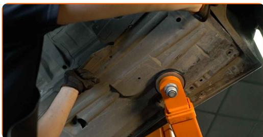
22 Privijte pritrdilne elemente plošče za pokrivanje spodnjega dela. Uporabite nasadni ključ №8. Uporabite nasadni ključ №10. Uporabite izvijač z zatikalom.
