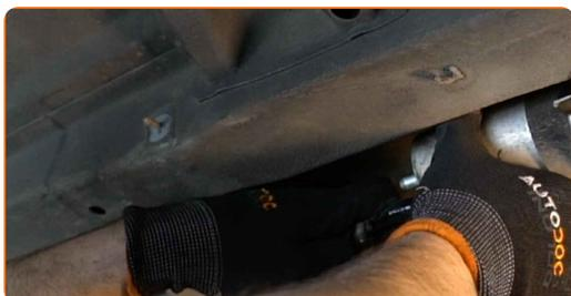
**13** Očistite namestitveni nosilec filtra za gorivo. Uporabite sprej WD-40.
