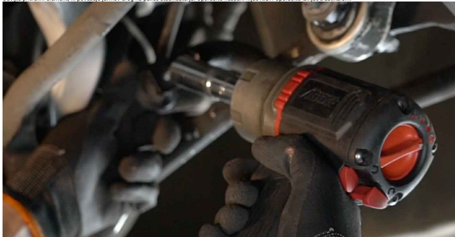
7 Odvijte pritrdilni element, ki povezuje jarmov drog na palico stabilizatorja. Uporabite nasadni ključ №17. Uporabite izvijač z zatikalom.
