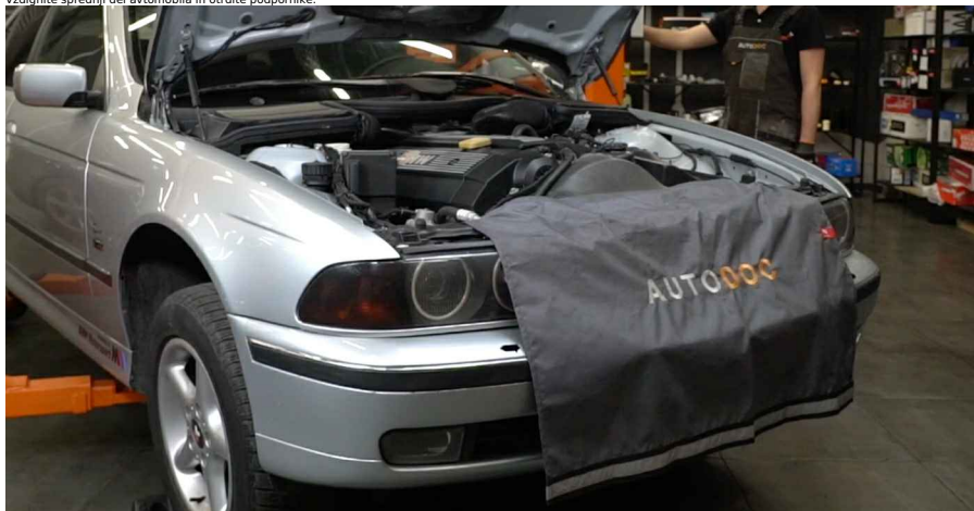
3 Vzdignite sprednji del avtomobila in otrdite podpornike.
