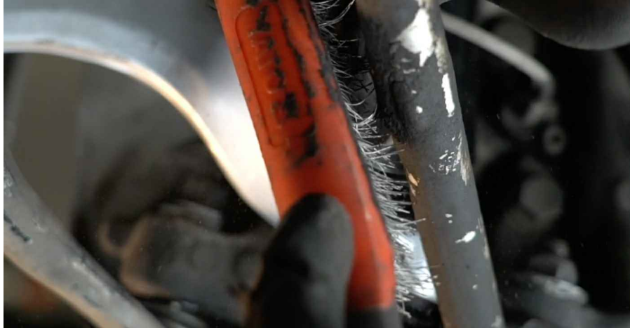
7 Odvijte pritrdilni element, ki povezuje jarmov drog na palico stabilizatorja. Uporabite nasadni ključ №17. Uporabite izvijač z zatikalom.
