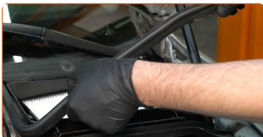
**7** Odstranite ohišje zračnega filtra kabine.
