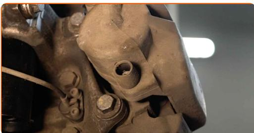
**15** Odvijte pritrditve zavorne čeljusti. Uporabite imbus št. H7. Uporabite izvijač z zatikalom.
