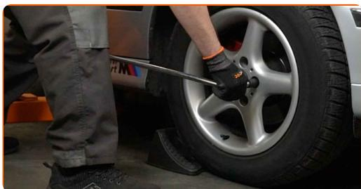
**11** Vzdignite sprednji del avtomobila in otrdite podpornike.
