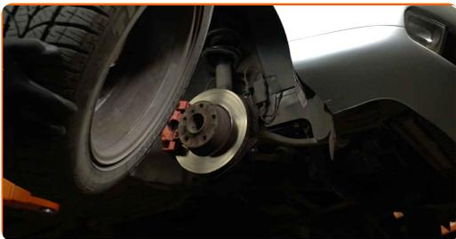
**14** Odstranite pokrovčke manšete vodilnih zatičev zavornih čeljusti. Uporabite lomilko.
