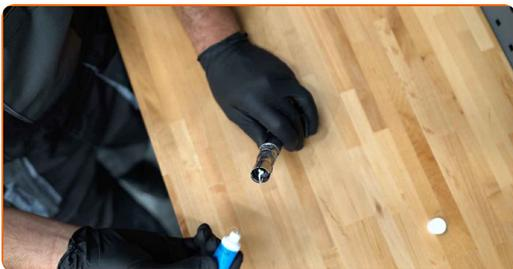
11 Obdelajte konektor vžigalne tuljave s sprejem za elektroniko. Sprej bo zaščitil električne kontakte pred korozijo, oksidacijo in bo zmanjšal upor kontaktov.
