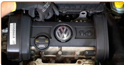
5 Odstranite pokrov motorja. Uporabite vijačni nastavek T30.
