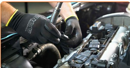
10 Obdelajte konico vžigalne tuljave. Uporabite visokotemperaturno mast.
