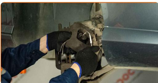
**20** Priklopite kabel senzorja obrabe zavornih ploščic.
