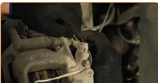
**21** Priključite vtič senzorja za obrabo zavornih oblog.
