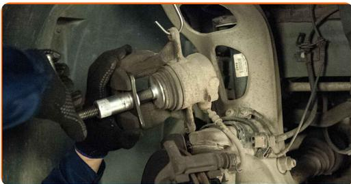
**19** Namestite zavorno čeljust in jo privijte. Uporabite kombinirani ključ №15. Uporabite nasadni ključ №13. Uporabite navorni ključ. Zategnite ga do navora 30 Nm.
