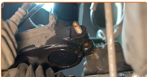
**52** Zategnite spodnje pritrdilne elemente vzmetne noge. Uporabite nasadni ključ №16. Uporabite navorni ključ. Zategnite ga do navora 55 Nm.
