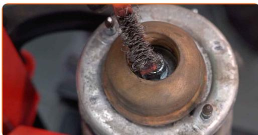
**20** Odstranite matico oporne batnice. Uporabite nasadni ključ №19. Uporabite izvijač z zatikalom.
