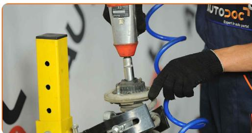
**21** Odstranite zgornji nosilec. Uporabite ploščat izvijač.
