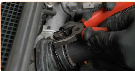
**5** Odstranite cev za dovod zraka.
