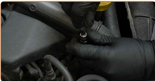
**4** Odstranite vpenjalni kos cevi za dovod zraka. Uporabite kombinirane klešče. Uporabite lomilko.
