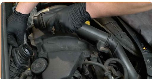
**6** Pokrijte cev za dovod zraka s krpo iz mikrovlakn, da preprečite vnos prahu in umazanije v sistem.
