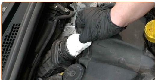
**22** Namestite cev za dovod zraka in jo pričvrstite.
